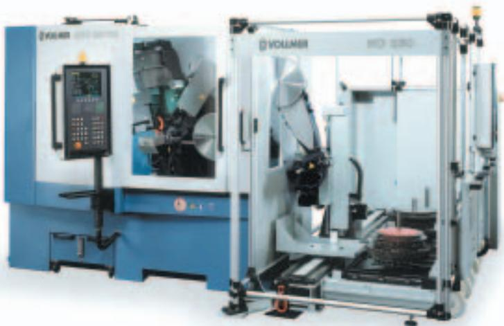
Der Schleifautomat CHD 251 R2 mit Robotersystem ND 230 als Service Center für die vollautomatische Komplettbearbeitung im Service.
