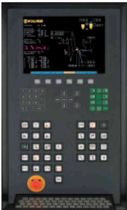
Das Bedienpult mit LCD-Farbdisplay und einfacher Bedienung.
