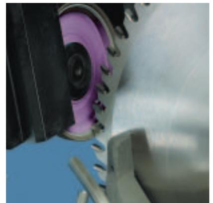
Beim Freischleifen des Blattkörpers wird in nur einem Umlauf der gewünschte Abnahmebetrag abgeschliffen.
