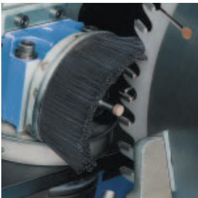
Zusätzliches Schleifgerät für genauen, symmetrischen Hohlzahnschliff.
