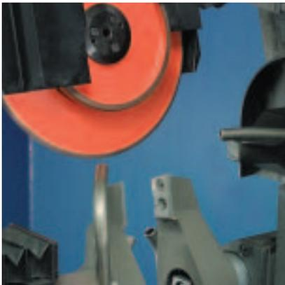
Die stabile Blattklemmung läßt sich weit nach vorne öffnen und erleichtert den Sägeblattwechsel.
