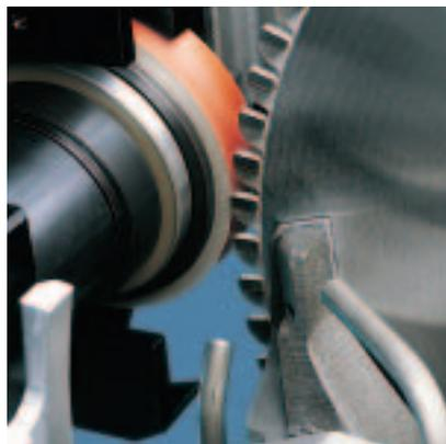
Schleifen einer Spanteilerrille bei HM- Sägeblättern.
