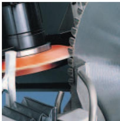
Schleifscheibensatz mit Scheiben für negativen Spanwinkel und für Rückenschliff.
