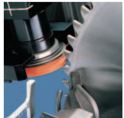
Schleifscheibensatz mit Scheibe für negative Spanfläche und der Scheibe für Spanteilerrille.
