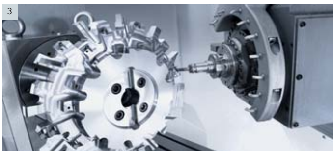
11–21 NC-gesteuerter Schwenkfräskopf als B-Achse für das simultane 5-Achs-Fräsen mit höchster Stabilität durch Bearbeitung im Achsen-Schnittpunkt 131 Teilapparat und B-Achse als Sonderlösung z. B. für die Werkzeugherstellung 141 NC-gesteuerte A-Achse – für das simultane 5-Achs-Fräsen mit negativen Winkeln bis -30^\circ
