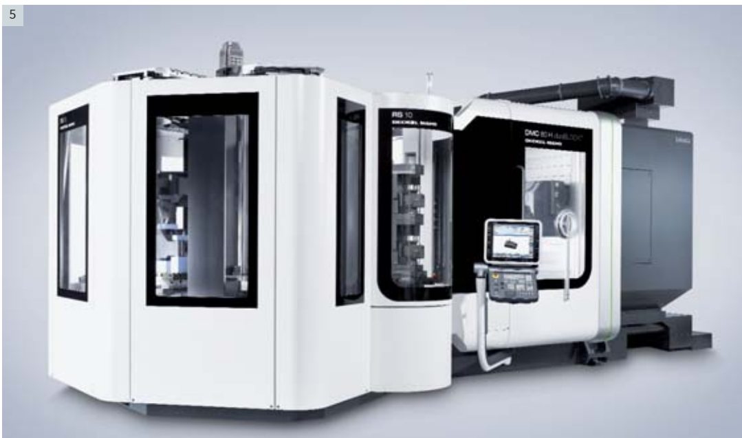
1|1 DMC U als Palettenpeicher mit Containerlösung 1|2 Fertigungssystem mit drei Bearbeitungszentren, 2-etagigem Linearspeicher mit 52 Plätzen und zentralem Werkzeugmagazin mit 400 Plätzen 1|3 Fertigungszelle für Hydraulikkomponenten 1|4 Vollautomatische Fertigung von Getriebegehäusen 1|5 DMC 80 U duoBLOCK® mit Rundspeicher RS10 1|6 Rundspeicher RS5
