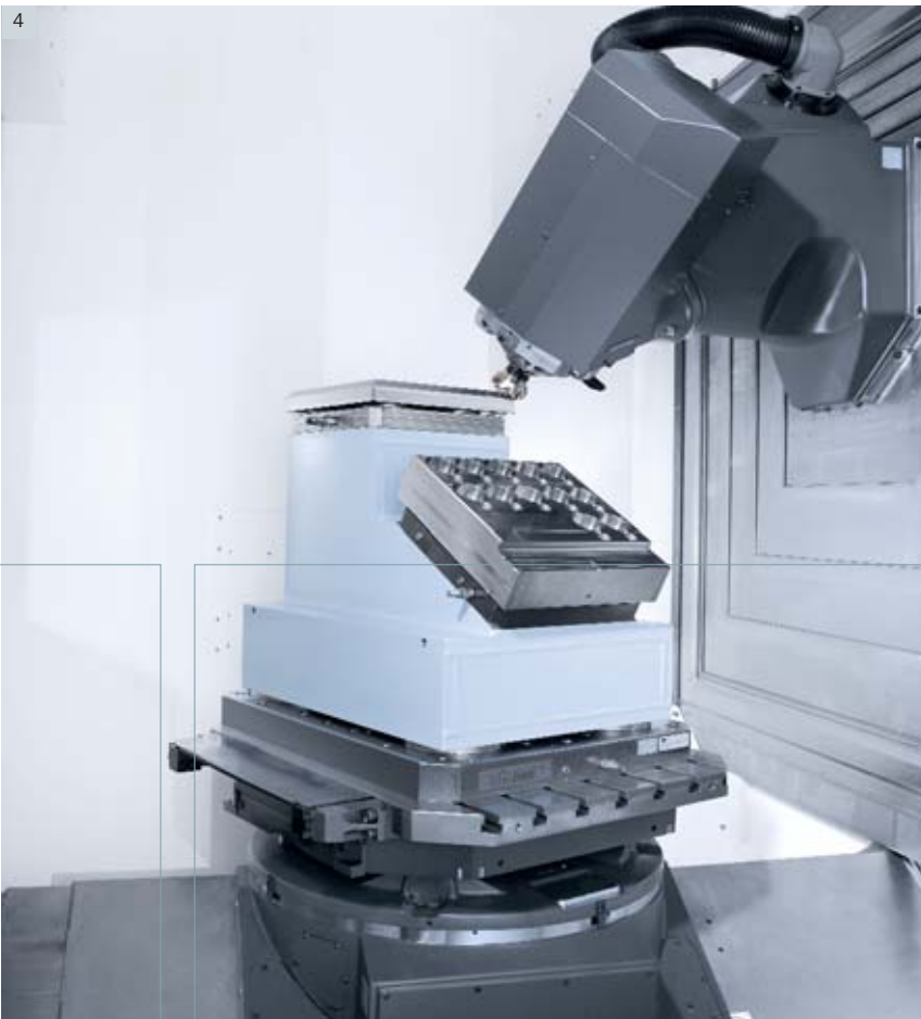
14| Großer kubischer Arbeitsraum und konstante Genauigkeit auch im oberen Verfahrbereich durch drei Führungen in der X-Achse 15| Steile (30°) und einteilige Abdeckungen im Bereich des Spänefalls 16| Schnelle Späneentsorgung nach hinten und aus der Maschine
