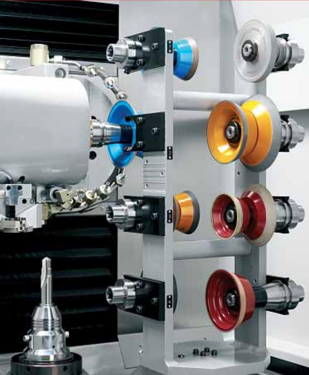
Der serienmäßig in die S22P integrierte 8-fach Schleifkörperwechsler
