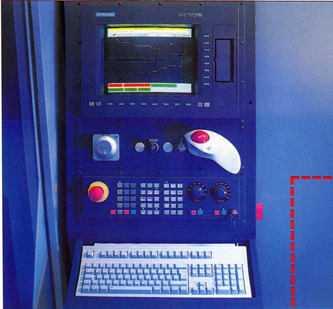
Komplizierte Werkstückformen lassen sich über die Online-Grafik an der Steuerung programmieren. Ergonomisch angeordnete Bedienelemente sowie Zeigergeräte ermöglichen eine leichte Bedienung der Windows-Oberfläche.
