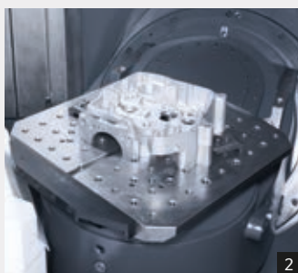
2-5: Der enorme Schwenkbereich des NC-Schwenkrundtisches lässt keine Wünsche in der Komplettbearbeitung offen
